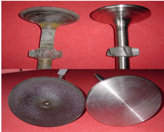
Figura 15 a/b: vástago de Nimalike antes y después de la refabricación.
