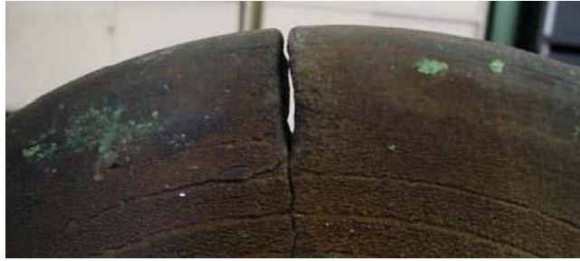
Figura 14: fallo de un vástago de válvula (RTA84 tipo Nimonic, 5.270 horas tras la reparación).
