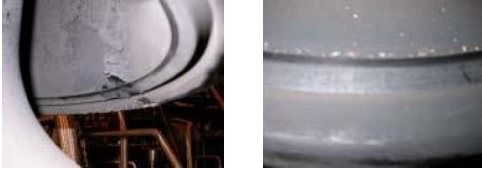
Figura 19: el anillo de asiento y el vástago de válvula no muestran marcas después de unas 1.000 horas.
