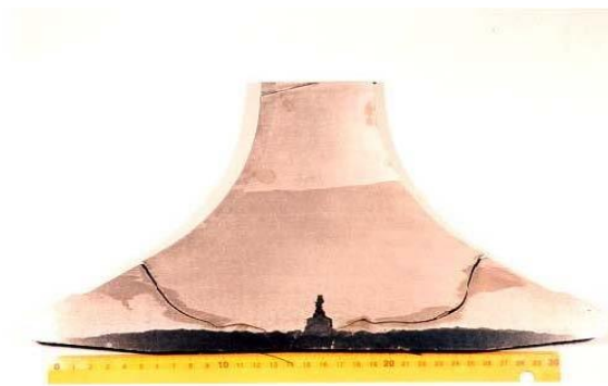
Figura 13: macro corte por el centro de una cabeza de válvula (RTA62 tipo Nimonic, 6.430 horas tras la reparación).
