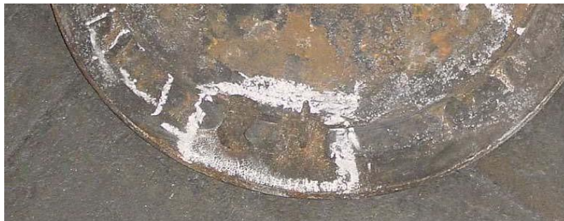
Figura 08: el aspecto de la “corrosión de guijarro” del fallo del vástago de válvula debido a corrosión por alta temperatura (tipo estándar MC60)
