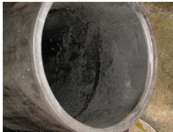
Figura 04b: depósitos típicos en el diámetro interno de la guía de válvula (tipo MC70 tras 8.200 horas)
