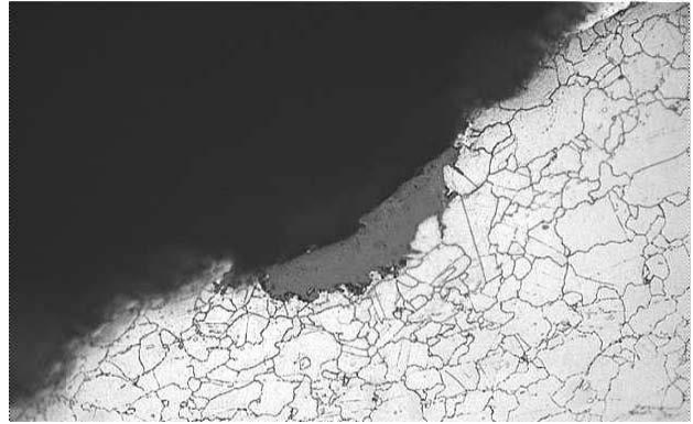
Figura 07: corrosión por baja temperatura (ataque con corrosión crateriforme) por debajo del radio de cabeza del vástago de válvula (MC60-estándar / 22.700 horas)
