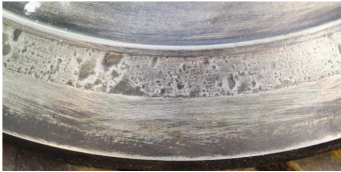
Figura 03: Las marcas de dientes normales del asiento de válvula (tipo MC60 Nimonic tras 8.300 horas)
