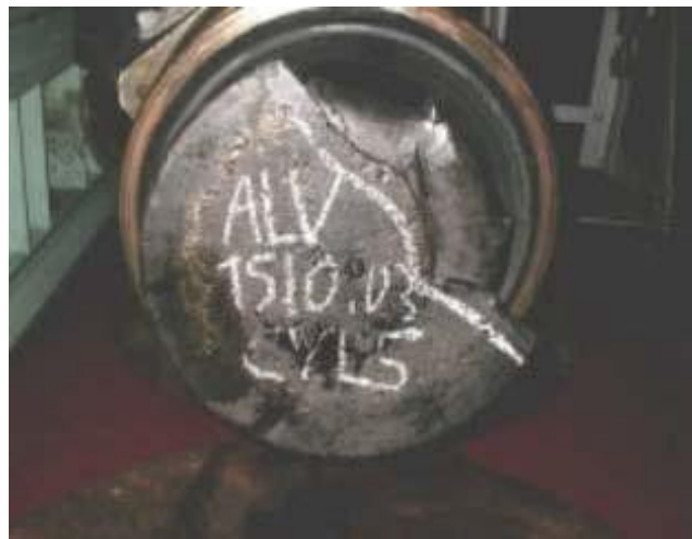
Figura 12: fallo catastrófico de un vástago reparado de válvula (RTA72 tipo Nimonic, 740 horas después de la reparación)
