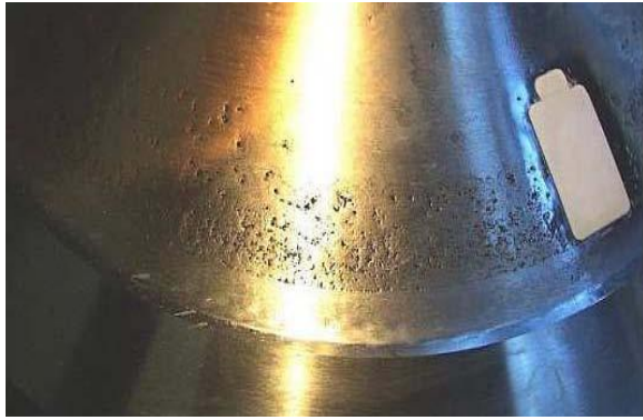
Figura 07: corrosión por baja temperatura (ataque con corrosión crateriforme) por debajo del radio de cabeza del vástago de válvula (MC60-estándar / 22.700 horas)
